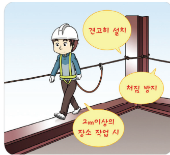
안전대 및 부착설비 설치
