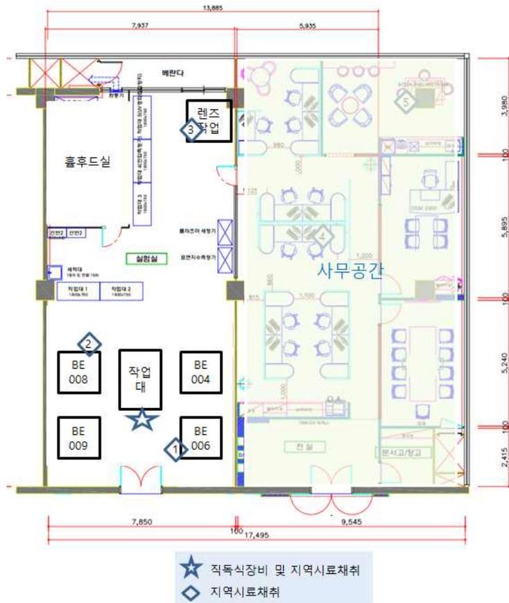
[그림 II-4] C 사업장의 배치도 및 주 측정위치
