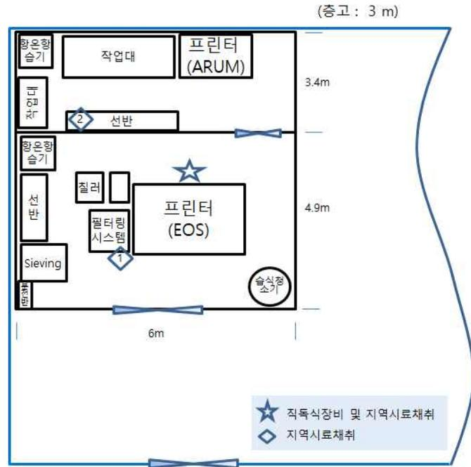
[그림 II-5] D 사업장의 배치도 및 주 측정위치
