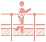
**비계(Scaffold, Scaffolding)**란 작업장소가 높아서 작업자가 손이 닿지 않는 높은 곳을 작업할 수 있도록 공사용 통로나 작업용 발판 설치를 위하여 구조물의 주위에 조립, 설치되는 가설구조물을 말한다. 또한 비계는 부재의 설치·해체작업, 구조물작업, 조적작업, 미장작업, 도장작업, 볼팅작업, 용접 또는 용단 작업 등을 할 때 노동자가 작업장소에 접근하여 작업할 수 있도록 설치하는 가설작업대를 지지하는 구조물을 의미한다.
