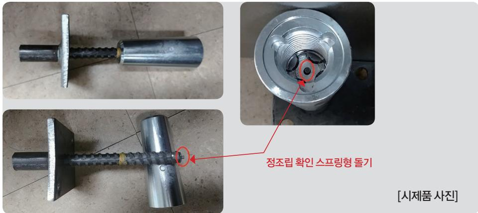
**개발된 장치의 특징**은 클라이밍 콘과 타이로드의 체결길이 확보를 육안 등으로 확인이 용이하고, 콘크리트 타설 전에는 체결위치 확인부(스토퍼2)와 콘 밀착으로 쉽게 확인이 가능하며, 콘크리트 타설 후에는 콘 볼트 체결 전 스프링돌기 돌출 여부로 육안 확인이 가능하다. 또한, 휴먼에러 예방을 위해 앵커플레이트의 유효 영역을 설정하여, 앵커 플레이트 설치 후 철근 등 간섭 발생 시 위치를 미세하게 조정이 가능하도록 하였다.
