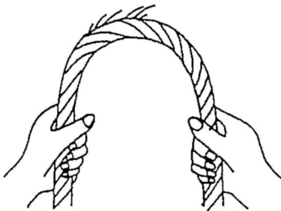
2. 정기 점검, 특별 점검 시는 로프 전반에 걸쳐 로프 지름을 측정합니다. 로프 지름은 외접원의 지름에서 1 개당 3 방향에서 측정하여 그 평균치를 내어 주십시오. 지름의 감소(신품시의 로프 지름 실측치에서 점검시의 로프 지름 실측치를 뺀 것)가 공칭지름의 3% 이상인 곳에 대해서는 스텝 1과 마찬가지로 로프를 굽히고 내부 단선의 유무를 확인합니다.
