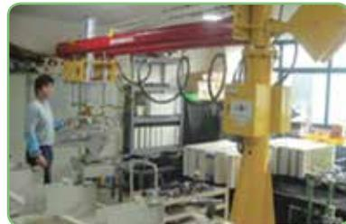
인력으로 중량물인 피도금체 취급 작업을 대체할 수 있는 도금공정 자동화 설비 설치
