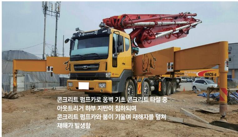
콘크리트 펌프카로 옹벽 기초 콘크리트 타설 중 아웃트리거 하부 지반이 침하되며 콘크리트 펌프카와 붐이 기울며 재해자를 덮쳐 재해가 발생함
