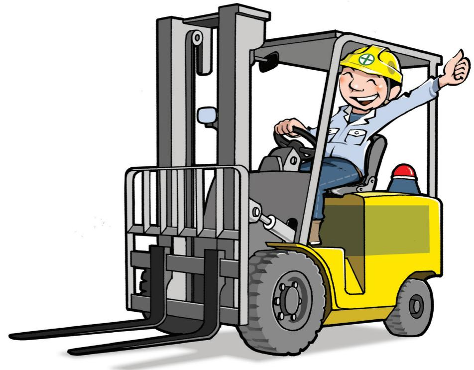
지게차는 하물 적재장치인 포크 fork · 램 ram , 승강장치인 마스트 mast 등이 차의 전면부에 장착된 하역용 자동차로서 포크리프트 fork lift 라고도 부른다. 지게차는 제조 · 건설 · 운수 · 도소매업 등에서 중량물의 적재 · 하역 · 운반 용으로 널리 사용되고 있다.
