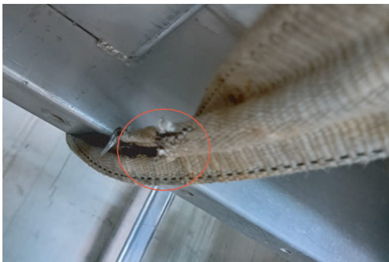
승강기 지지용 슬링벨트 볼트 등 열에 손상되어 절단 위험 ☞ 승강기 지지용 슬링벨트 즉시 교체
