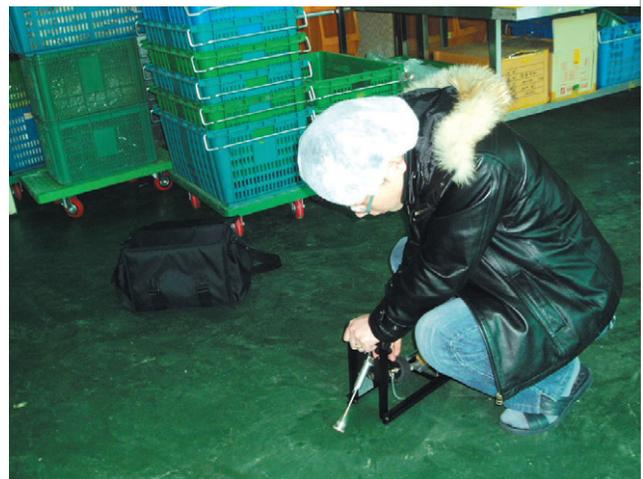
[그림] 음식료품 제조공장의 작업장 바닥 미끄러짐 지수 측정 장면
