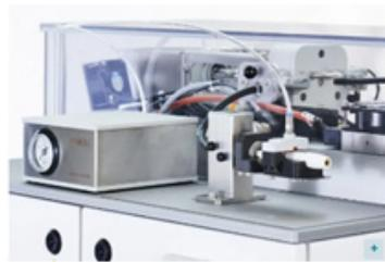
[그림 II-5] 담배 발생장치(VITROCELL<sup>®</sup> Smoking machine)
