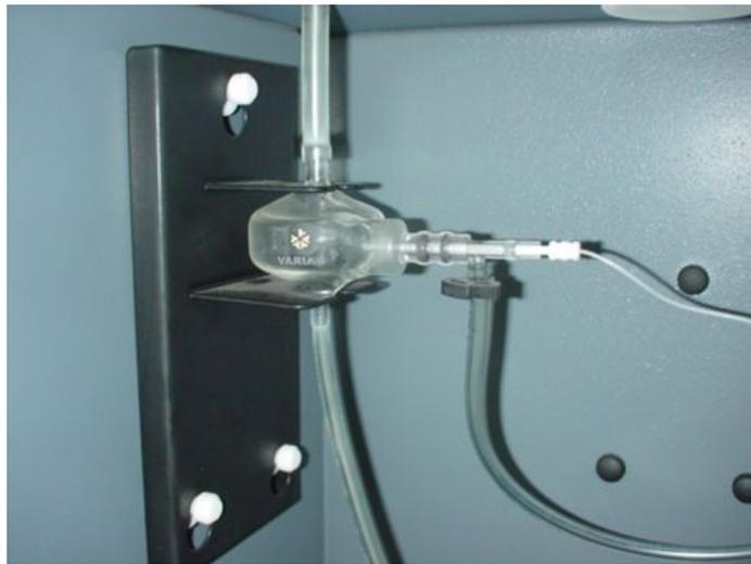
그림 7. ICP의 시료주입부(분무기 및 스프레이 챔버)
