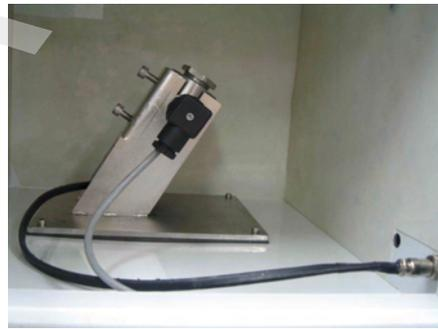
[그림 38] 시간-압력(Time-Pressure) 시험기 사진
